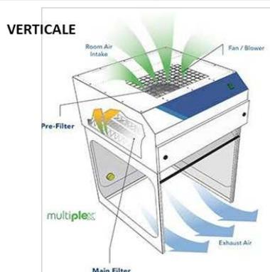
**Efficacité:** Protection de la manipulation mais pas du manipulateur ou de son environnement. Ne doit pas être utilisée pour des manipulations de microorganismes pathogènes.
