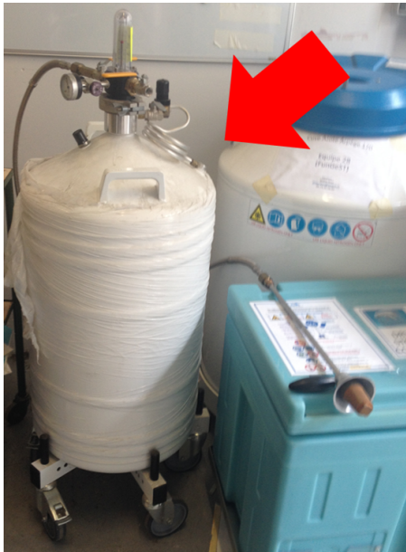
Nourrice pour soutirer de petites quantités d'azote liquide
